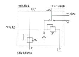
组合制动阀由减压阀,卸荷阀和往复阀组成。减压阀将来自后制动储能器的液压油压力降低,卸荷阀 调节压力,经减压阀后提供后制动管路中余压,往复阀依据柱塞位置,为后制动管路提供余压,在脚踏 阀或缓行器阀促动后,制动器促动压力克服余压,在后制动盘上产生制动作用。
