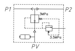
先导阀又为压力控制阀,它将来自液压泵供应的压力降至为3MPa和3.5MPa之间。先导阀与预充氮气1.3MP的储能器安装在一起。
