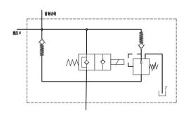
当按下50%的减压开关(电磁阀通电开关),可使制动压力减少一半,从而改善车辆在光滑,泥泞路面上的制动性能。电磁阀不通电,由驻车制动阀直接经阀芯供油制动卡钳,电磁阀通电经减压阀供油制动卡钳。
